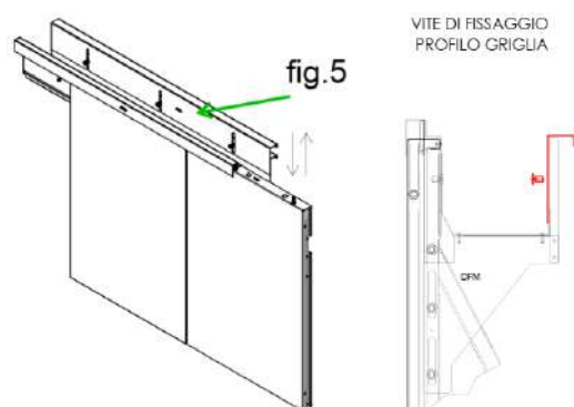
Fig.5 Fissare e regolare il profilo griglia con le viti 8x16 Da inserire sugli inserti in corrispondenza delle asole.
