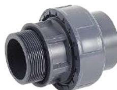
BOCCHETTONE MASCHIO FILETTATO CON O-RING/F INCOLLAGGIO
